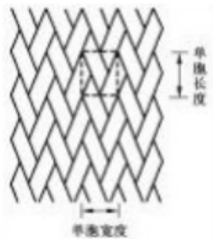
图 3 三维编织物表面组织结构示意图
